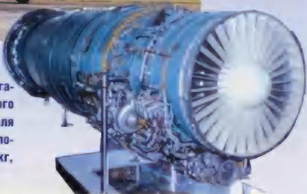
**R15B-300** - турбореактивный двигатель для первого отечественного высотного сверхзвукового истребителя МиГ-25 с максимальной скоростью полета 3000 км/ч, взлетная тяга 11200кг, серийно производился с 1969 года.
